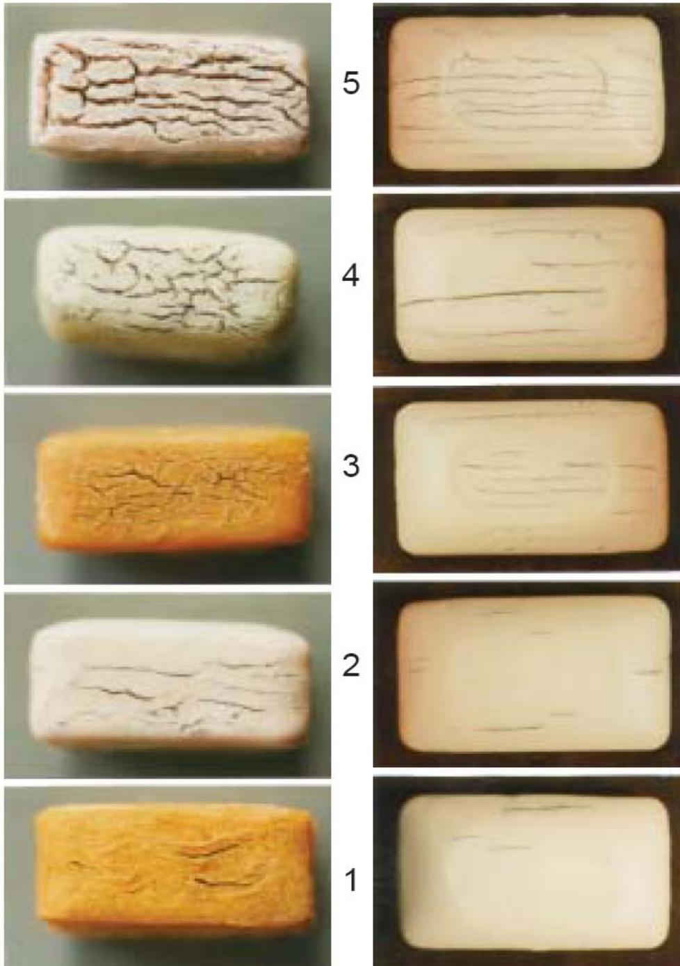
*End cracking scale*
